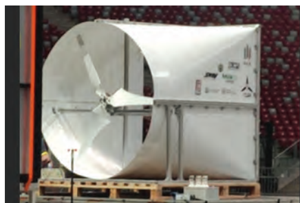
Rysunek 6. Turbina wraz z dyfuzorem opracowana w ramach studenckiego programu AGH WIND
