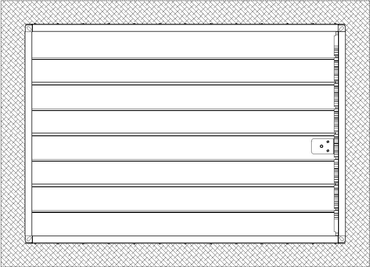
Rysunek 12. Sposób montażu klap WKP-O w podatnych konstrukcjach ściennych
