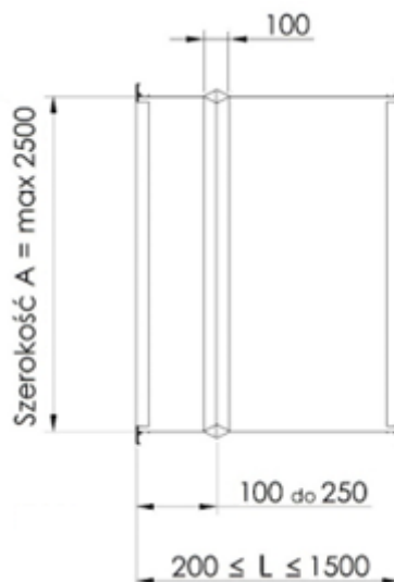
Rysunek 2. Zasady wymiarowania kanałów kompensacyjnych SDS-DC
