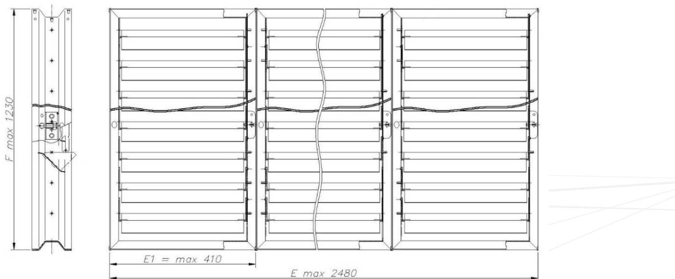
Rysunek 13. Zasady wymiarowania przepustnic SDS-GS
