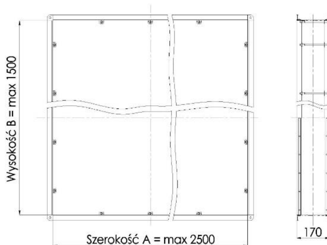
Rysunek 3. Zasady wymiarowania kompensatorów SDS-KE
