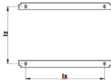
Rysunek 2. Wymiary stóp montażowych do wentylatora SEF(R) dla pozycji poziomej
