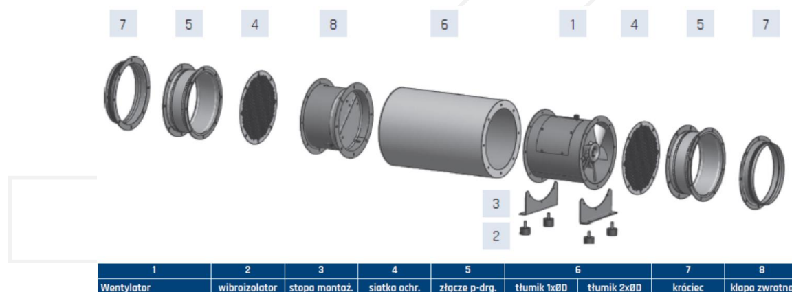
Rysunek 6.72 Schemat montażu kanałowych wentylatorów AFC
