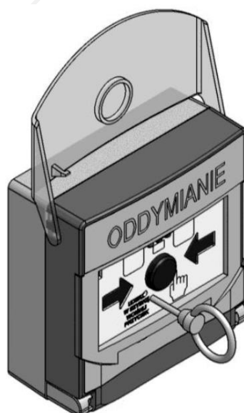
Rysunek 6.22 Wciśnięcie przycisku reset (występuje w POZ-2 i POZ-3)
