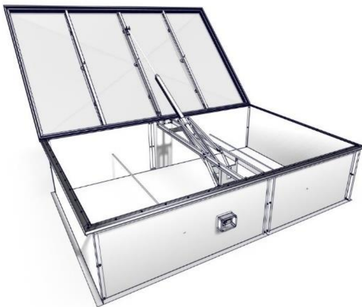
Rysunek 6.40 Klapa dymowa SCD-1-L
