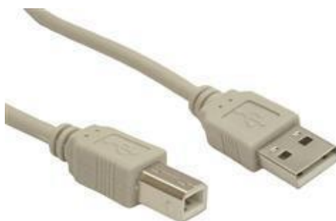
Rysunek 6.6 Przewód USB typu A-B do komunikacji z N-0200
